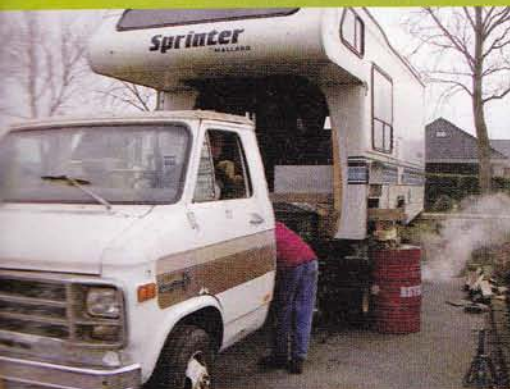
Het plaatsen van de opbouw is een secure klus.
